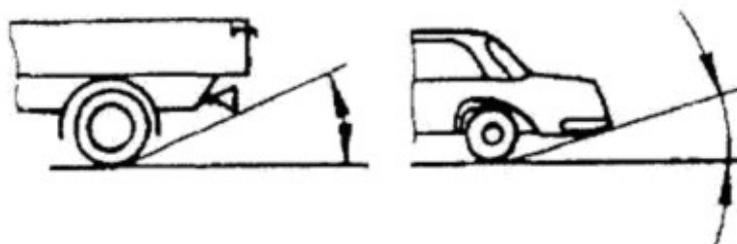
Рисунок 2. Угол съезда
