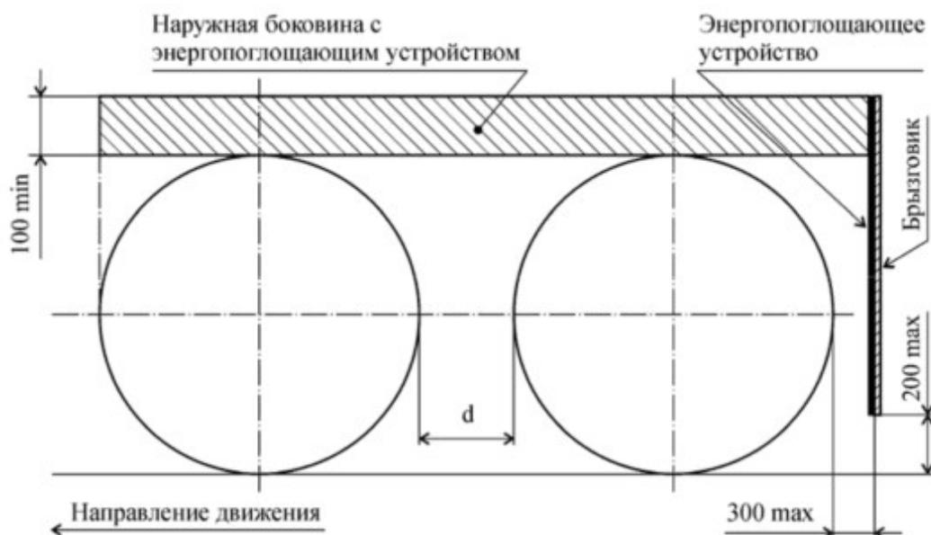
б) Одиночные оси и оси многоосных транспортных средств при расстоянии между шинами  $d$  не менее 250
