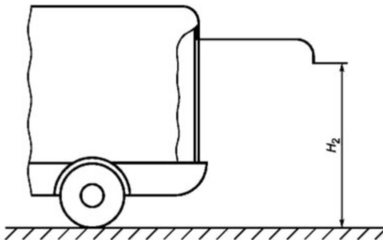
Рисунок 1.6.2. Высота задней двери в открытом положении
