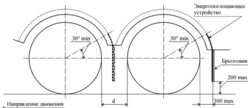
$d \leq 300$  мм - расстояние между шинами, установленными на соседние оси;  $j$  - наружная боковина;  $\theta$  - угол между горизонталью (O - Y) и плоскостью, проходящей через ось колеса (O - Z); U - высота краев боковины; W - расстояние между нижними крайними точками краев боковины; T - протяженность грязезащитного кожуха; R - радиус шины, установленной на транспортное средство;  $R_v$  - расстояние по радиусу от оси колеса до наиболее удаленной точки внутренней кромки наружной боковины
