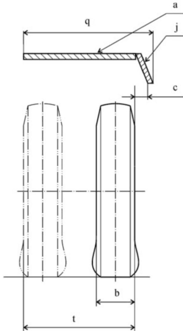
а - грязезащитный кожух; j - наружная боковина; с - расстояние между боковой поверхностью шины и наружной боковиной; q - ширина грязезащитного кожуха вместе с наружной боковиной; b - ширина шины; t - ширина сдвоенных шин.
