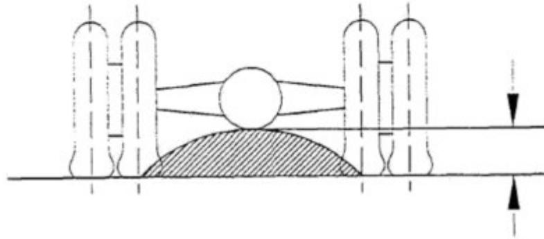
Рисунок 5. Дорожный просвет под одной осью
