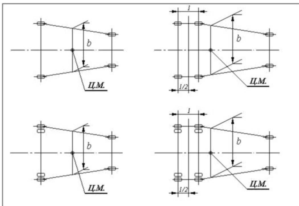
Рисунок 4.1. Схемы определения величины приведенной колеи "b"
