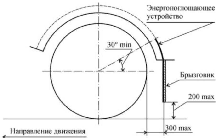
$j$  - наружная боковина,  $\theta$  - угол между горизонталью (O - Y) и плоскостью, проходящей через ось колеса (O - Z), T - протяженность грязезащитного кожуха.  $R_v$ , R - см. рисунок 9.3
