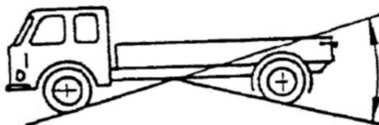
Рисунок 3. Продольный угол проходимости
